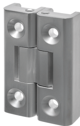
► FS605854 cerniera completa in alluminio, con boccola in nylon e spina in acciaio, per ante tavolini etr. 500 brand av.
